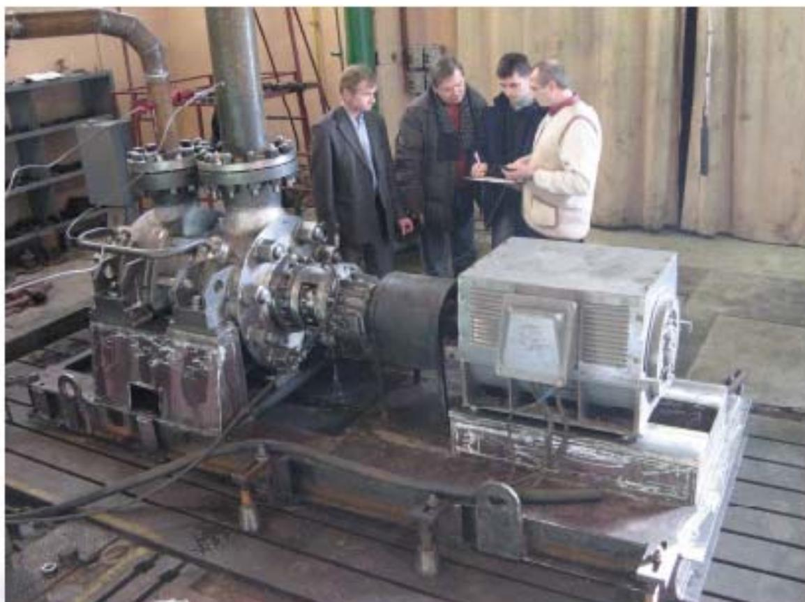
*Приемо-сдаточные испытания насосного агрегата АНДМс 250-380 (ЧАО «ЛИНИК») в испытательной лаборатории ООО «СМЗ», 2011 г.*
