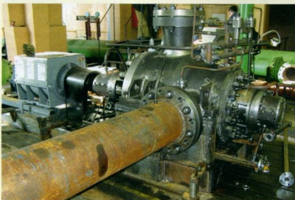
Рис. 2. Насосы НДМг 600-320 на испытательном стенде
